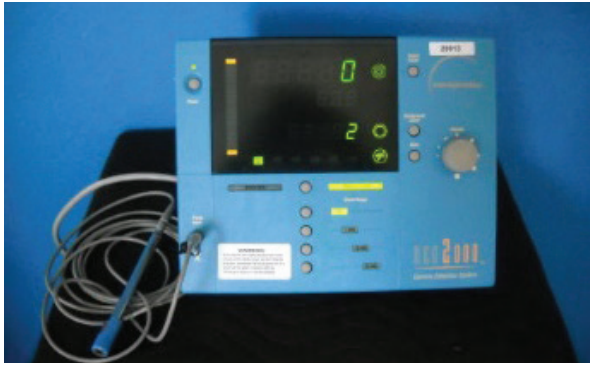
(Kiri) Prob Gamma (Neo2000) yang digunakan dalam prosedur SLNB di dewan bedah manakala (kanan) Pegawai Sains (Fizik) sedang membuat pengukuran radiasi
